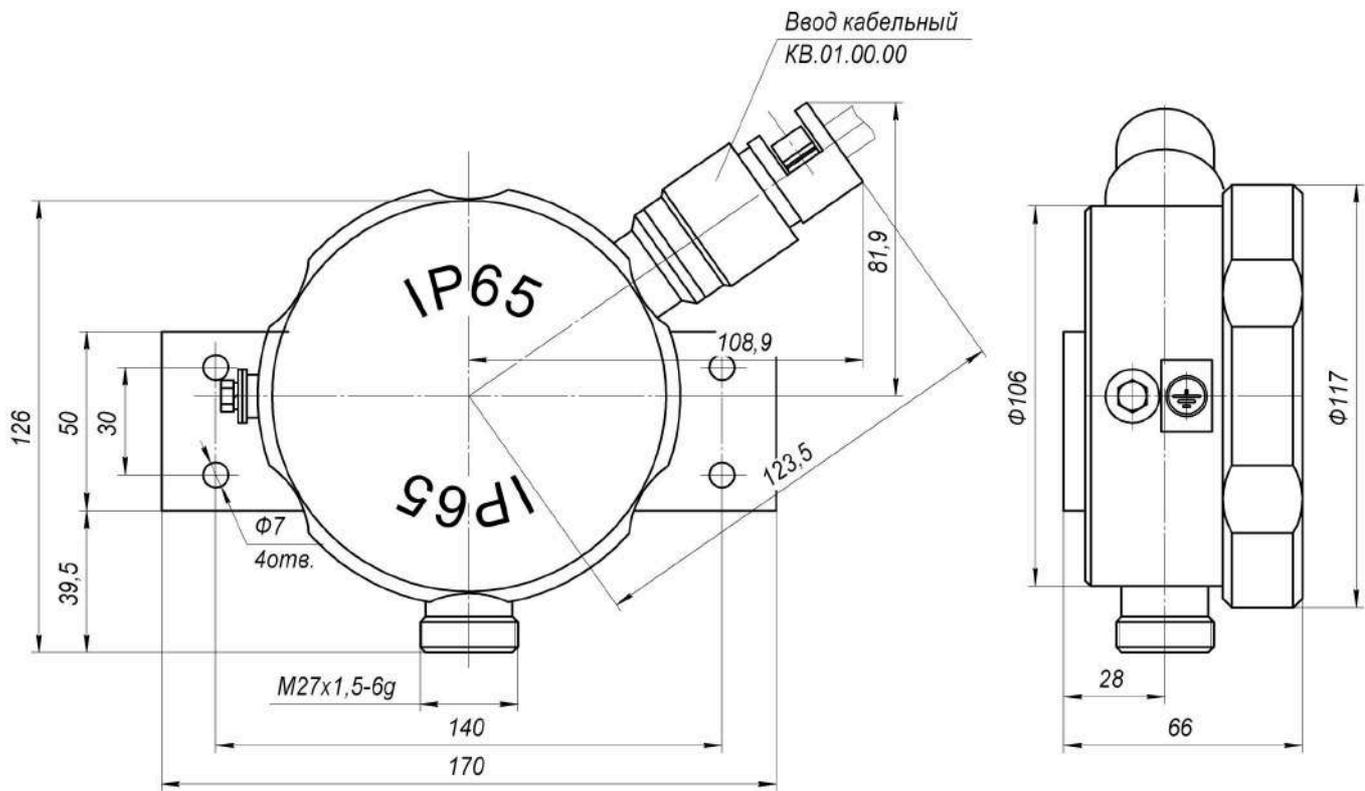
Рисунок А.8 - Корпус КП2М («Н» ПП из стали 12Х18Н10Т)
