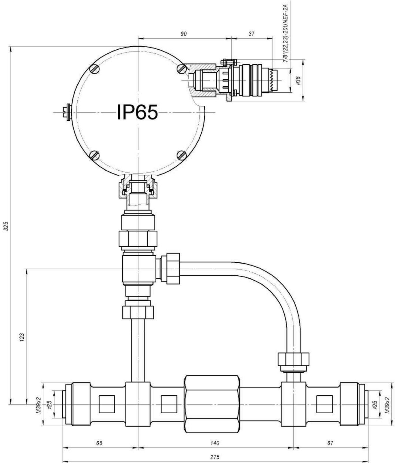
Рисунок А.7 - Первичный преобразователь анализатора АЖК-3101М.1(2;К).Э.Т в комплекте с проточным датчиком и байпасным контуром и разъёмным подключением
