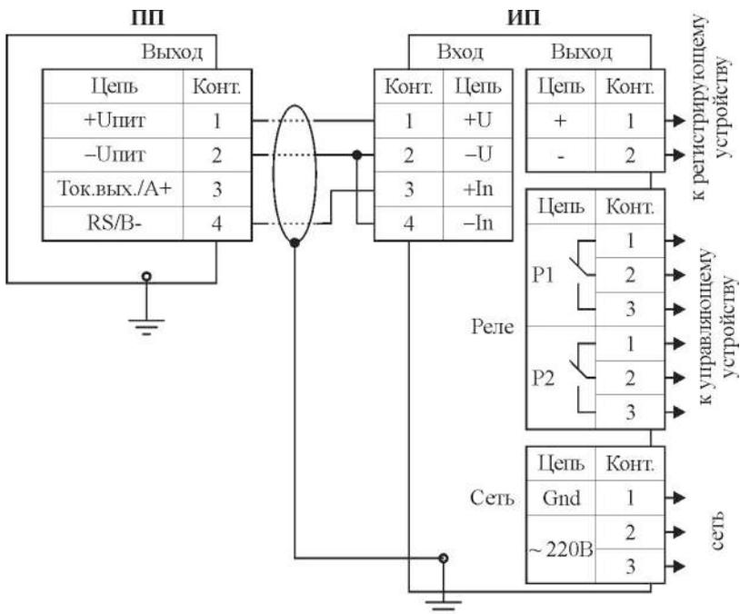
Рисунок С.2 – Подключение первичных преобразователей «И», «Н», «Т» (со светодиодным индикатором) к измерительному прибору
