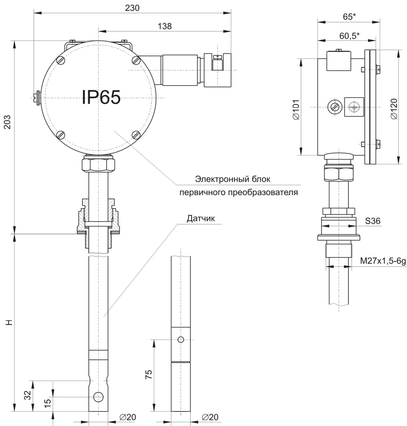
Рисунок А.3 – Моноблочный первичный преобразователь анализатора
